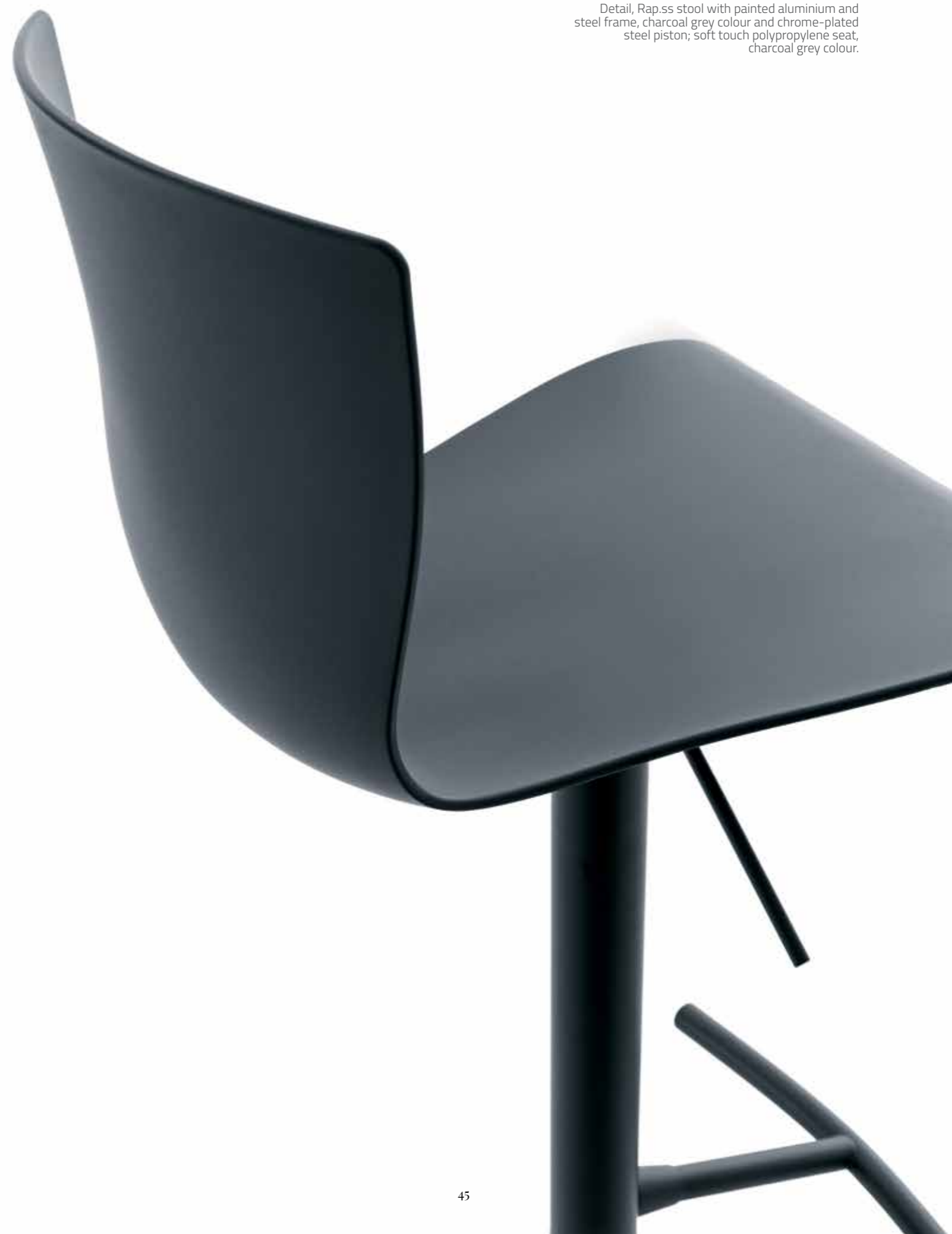
Dettaglio, sgabello Rap.ss con base in alluminio e struttura in acciaio verniciato, colore grigio antracite e pistone in acciaio cromato; seduta in polipropilene soft touch, colore grigio antracite.
